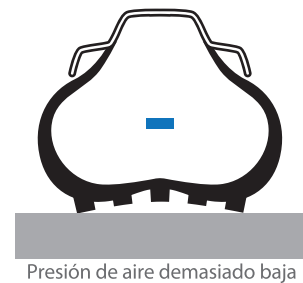
Presión de aire demasiado baja
